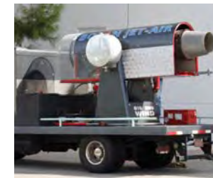
高速度ジェットエンジンによる 耐風圧のテスト
